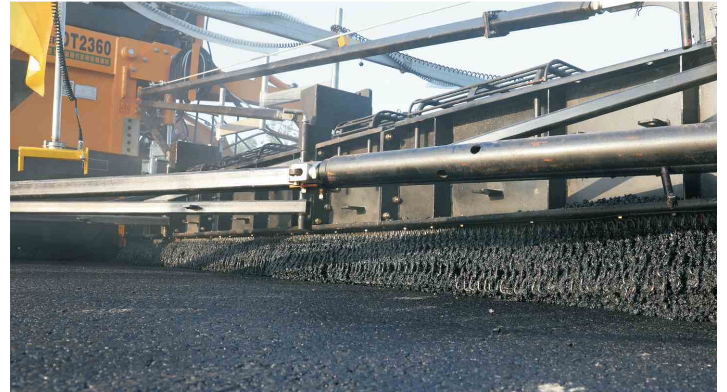
形成半封闭料仓的防治竖向离析装置
