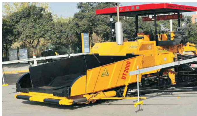
3) 双料斗、伸缩式、整体滑动防离析快速卸料装置
