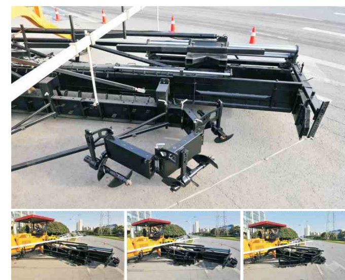
6) 螺旋多级折叠式防离析伸缩熨平装置
