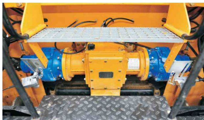
1) 具有不低于整机功率三分之二的大功率大扭矩螺旋动力装置
