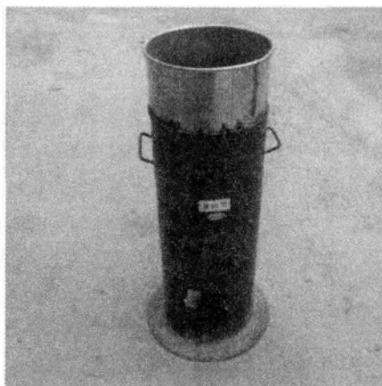
图3 \Phi 200 加长型灌砂筒
